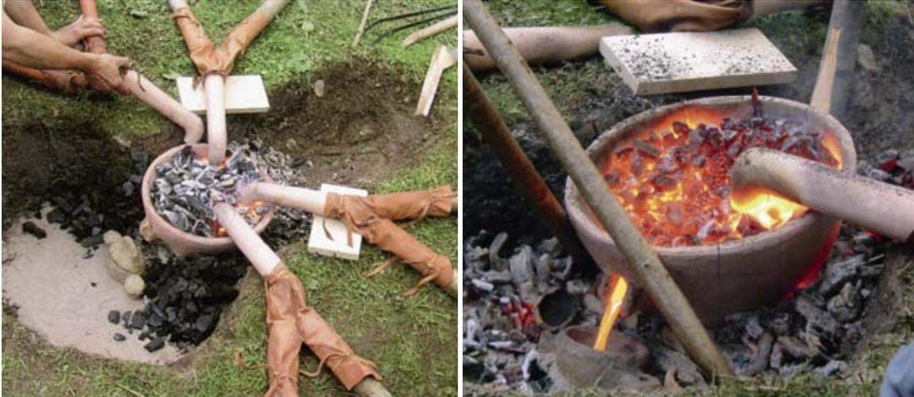
**Abb. 3: Die Bronze wird in einem Tiegel mit Hilfe von vier Tondüsen auf über 1100°C erhitzt. Die Gussform ist fast vollständig eingegraben. Über eine Öffnung in der Tiegelwand fliesst die Schmelze in den Eingusstrichter der Gussform.**
